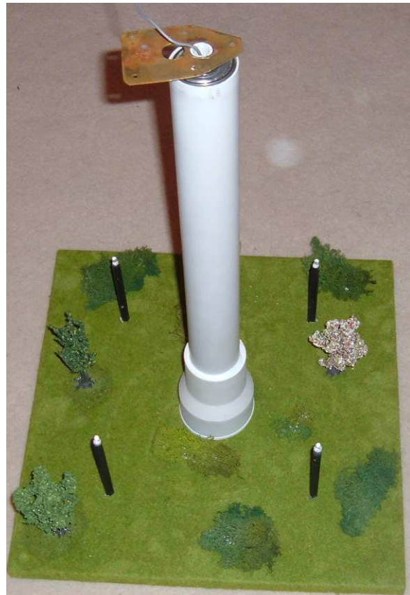
Βήμα 3 ο : Τοποθέτηση συστήματος μεταφοράς ηλεκτρικού ρεύματος από στρεφόμενη άτρακτο σε σταθερό σημείο – ρουλεμάν κατακόρυφου άξονα ατράκτου – βάση στήριξης ατράκτου
