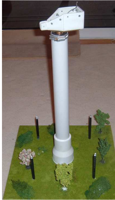
Βήμα 5 ο : Τοποθέτηση ατράκτου στον πύργο της ανεμογεννήτριας
